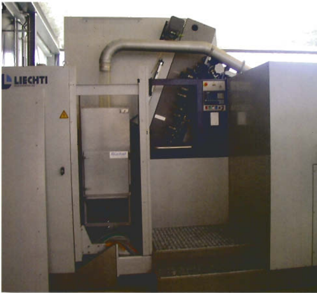
Bild 3: In Zusammenarbeit mit dem Maschinenbauer integrierte Büchel die Absauganlage in das Bearbeitungszentrum (Werkbilder: Büchel GmbH, Niederstotzingen)
