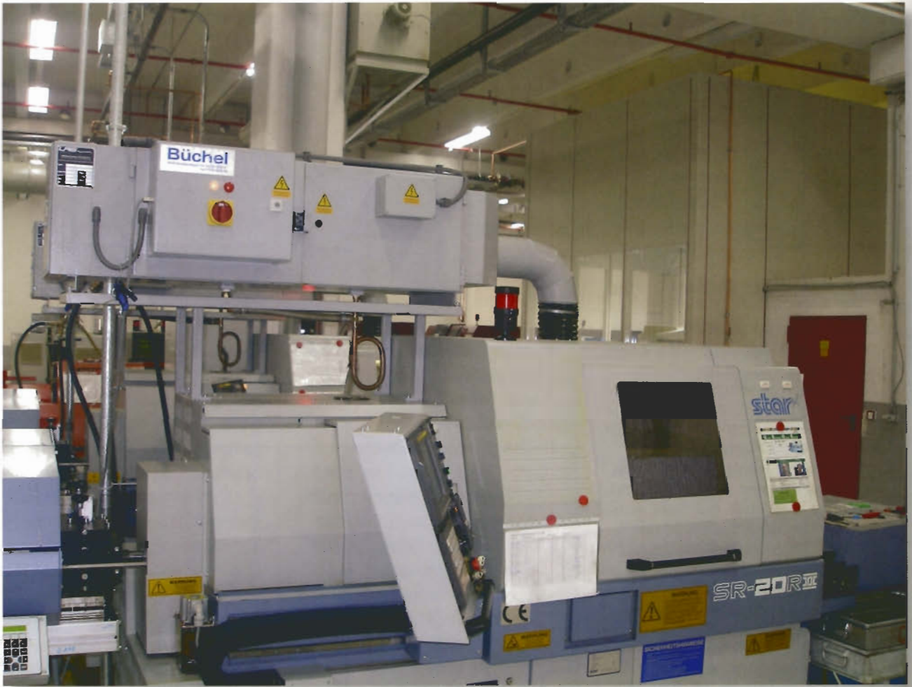
Bild 1: Die Ölnebelabsaugung ist auf die Anforderungen der Langdrehmaschine zugeschnitten
