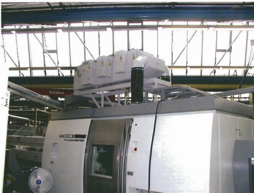
Bild 2: Die Einzelabsaugung für den Mehrspindelautomaten liefert Büchel inklusive Elektronik, Rohrleitungen Verkleidung, Filter und Zubehör
